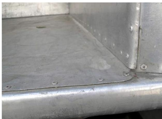
Фото 3. Неразъёмное соединение деталей при помощи заклёпок, обеспечивает высокую стойкость в условиях ударных и вибрационных нагрузок. Дополнительно производим уплотнение заднего и бокового дверного проема дверей.
