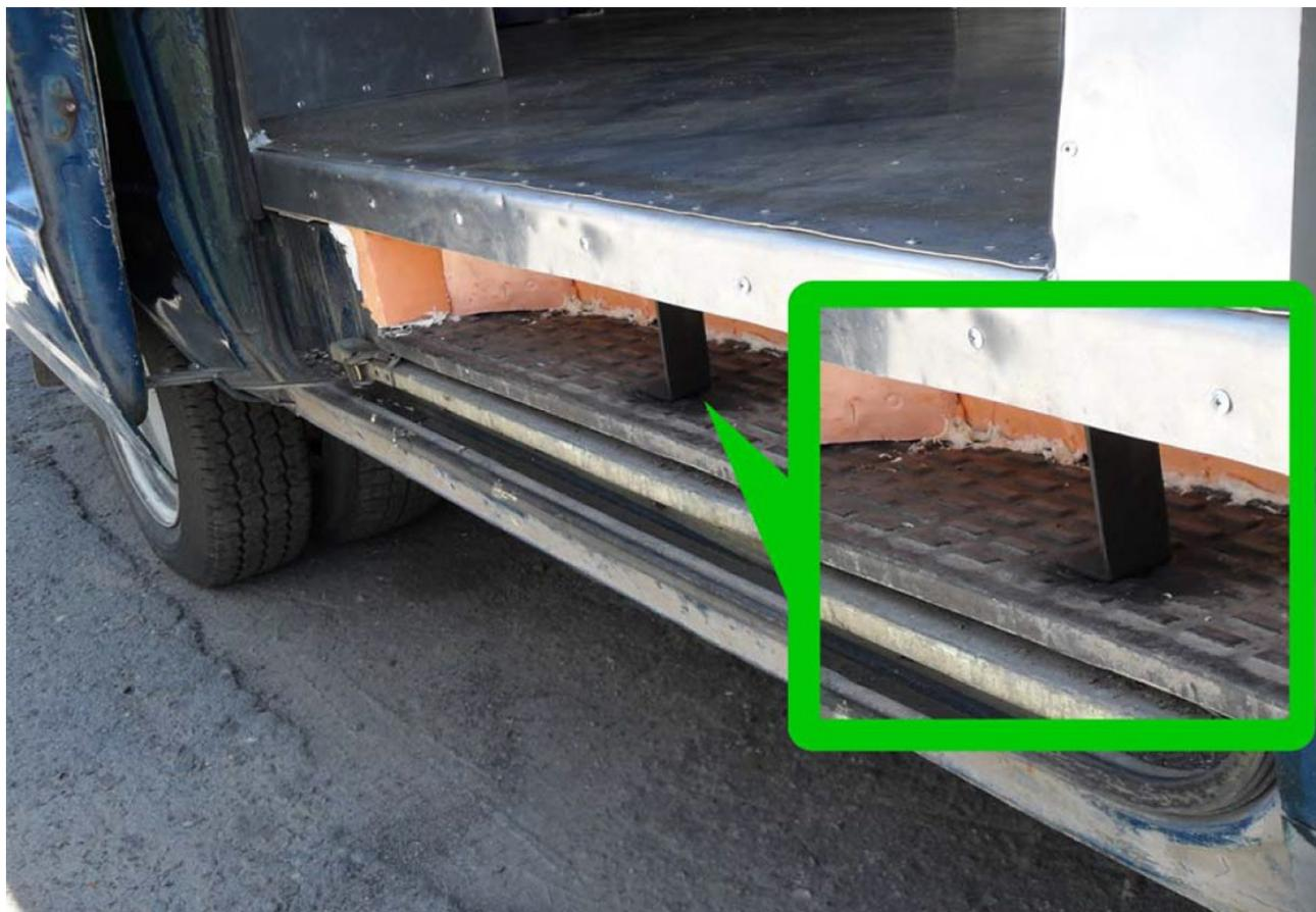
Фото 1. Опора утеплительной плиты пола. Кронштейн выполнен из стали. Дополнительно утепляем нишу подножки.
