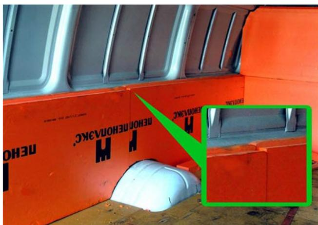
Фото 2. Измерьте ширину фургона до утепления и после, если ширина станет меньше 1 см, то вас надули. После нашего утепления ширина уменьшается на 10 см. Мы утепляем, а не надуваем наших клиентов. Кроме этого, для увеличения жёсткости потолка, мы устанавливаем дополнительную рамку для крепления конденсатора и испарителя.
